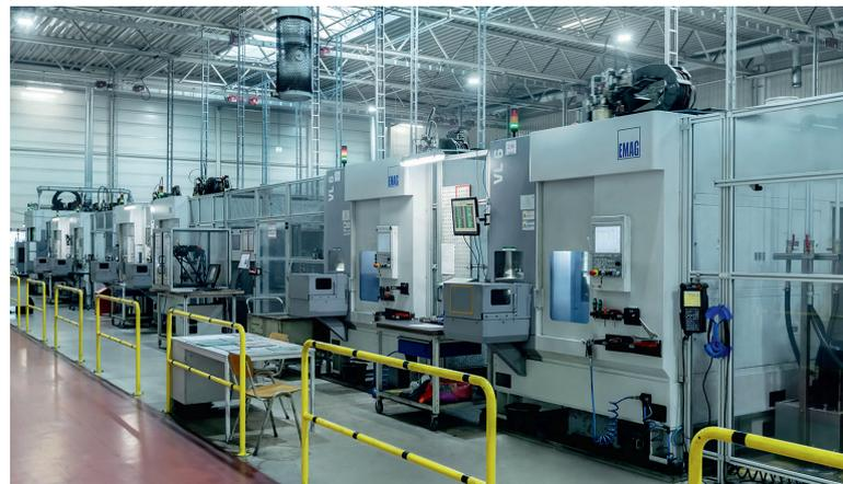
2 Für die Produktion des Ausgleichsgetriebegehäuse verfügt MAT insgesamt über fünf Produktionslinien mit jeweils sieben EMAG-Maschinen, die per TrackMotion verkettet sind © EMAG/Stephan H. Wieder
